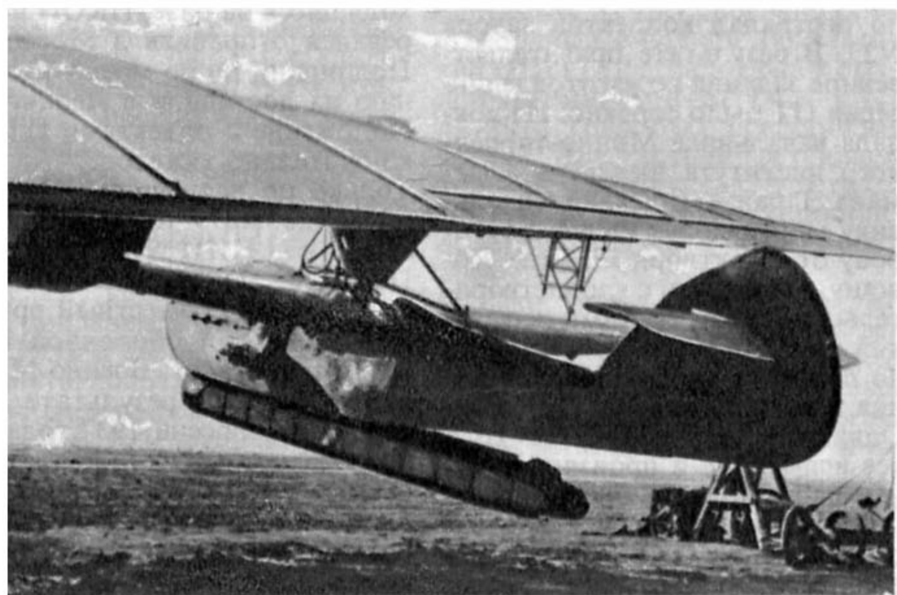
ПТ с различными видами полезных боевых грузов (сверху вниз): макетом ФАБ-1000, макетом ФАБ-500, зарядным отделением для ЗАБов.
