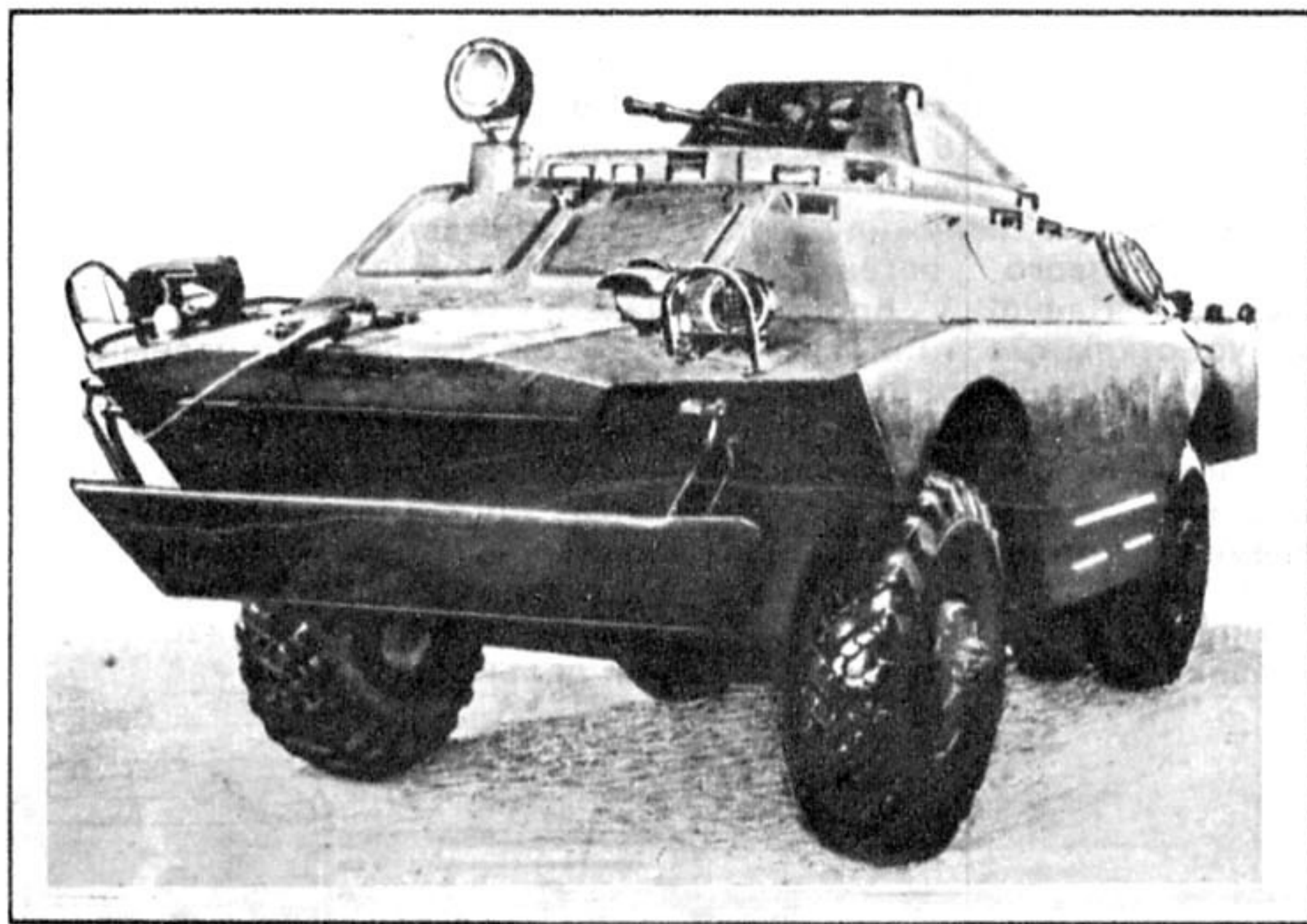
Рис. 6. Бронированная разведывательно-дозорная машина БРДМ-2: броня 10 мм; вооружение — 14,5- и 7,62-мм пулеметы; скорость 95 км/ч, на плаву 10 км/ч; экипаж 4 человека; масса 7 т.
