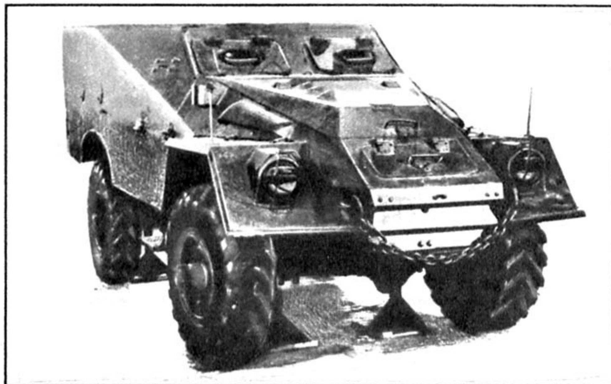
Рис. 4. Бронетранспортер БТР-40Б: броня 6—8 мм; вооружение — 7,62-мм пулемет; скорость 78 км/ч; экипаж с десантом 10 человек; масса 5,3 т.
